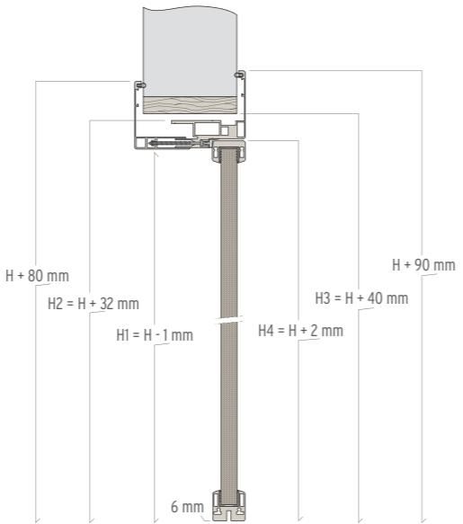
**Porta tamburata.** hollow-core door. porte en contre-plaqué. puerta de estructura alveolar. Furnierholztür. дверь с мелкопустотным заполнением
