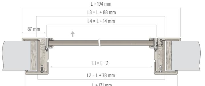
**Porta tamburata.** hollow-core door. porte en contre-plaqué. puerta de estructura alveolar. Furnierholztür. дверь с мелкопустотным заполнением
