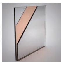
Multiprotect è un vetro costituito da due lastre, incollate tra di loro mediante una pellicola resistente allo strappo. In caso di rottura la pellicola lega i frammenti di vetro, prevenendo possibili lesioni. Questa elevata stabilità conferisce al vetro la sua efficacia antieffrazione e anticaduta. Elevato
